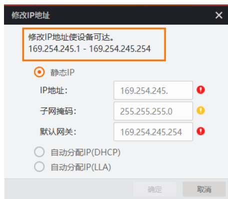
图4-5 修改 IP 地址
