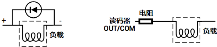
图 5-24 保护措施对应的接线
