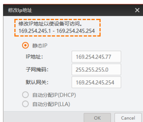
图4-5 修改 IP 地址
