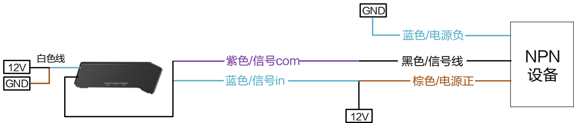
图7-6 输入信号接 NPN 设备（不使用上拉电阻）
