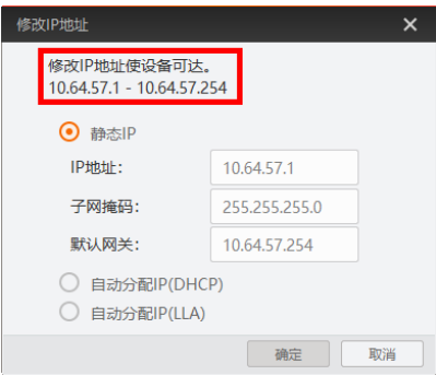
图3-9 修改 IP 地址
