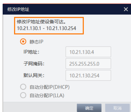
图3-14 修改 IP 地址
